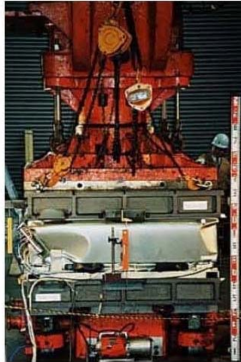
Module Crush Test
