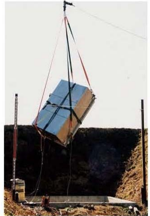
Module Drop Test
