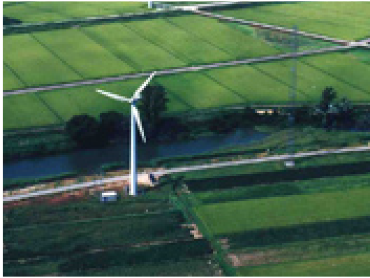
【図10】川沿いに建つ風車。川の中に落ちた死体は発見できないため、評価には補正が必要となる。(たちかわウインドファーム／山形県)
