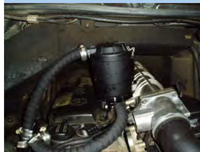
CCV3551KIT01 installed on a Mercedes Sprinter Van.
